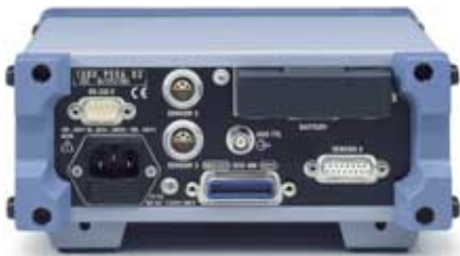
Akku, NAP-Messkopfanschluss und zwei weitere Anschlüsse für NRT-Messköpfe sind über die Rückseite zugänglich
